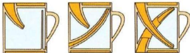
Внутреннее устройство «хитрых кружек» (авт. А. Калинин)
